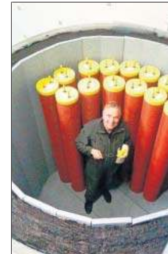
Siegfried Lessing in der Hülle des großen Wärmespeichers, der mit Latenzellen gefüllt und am Montag verladen wurde.
